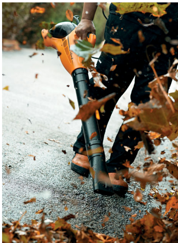
Die flache Düse liefert einen schnelleren Luftstrom für Präzisionsarbeiten in schwierigen Bereichen
