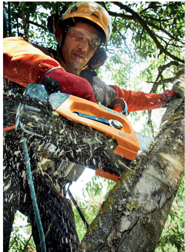
Schräger Schnitt aus dem Baum heraus
