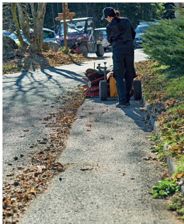
Die Neigungseinstellung der Bürste ermöglicht das Arbeiten mit höchster Präzision
